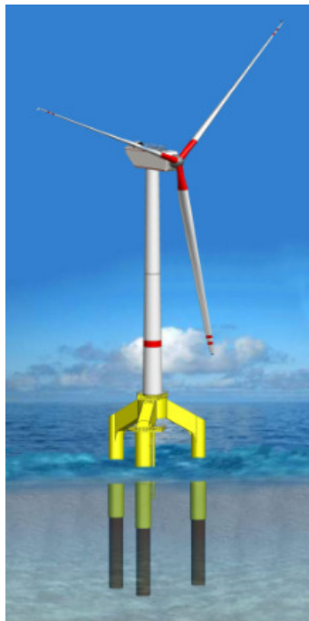
Figura 1.13: Estructura tripilote (Fuente: [9])
