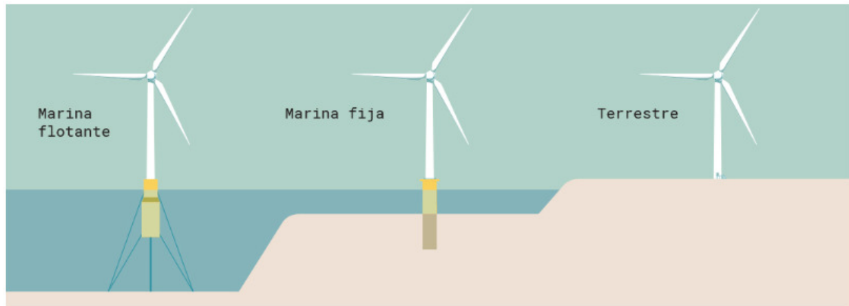
Figura 1.6: Tipos de cimentaciones de aerogeneradores (Fuente: [6])
