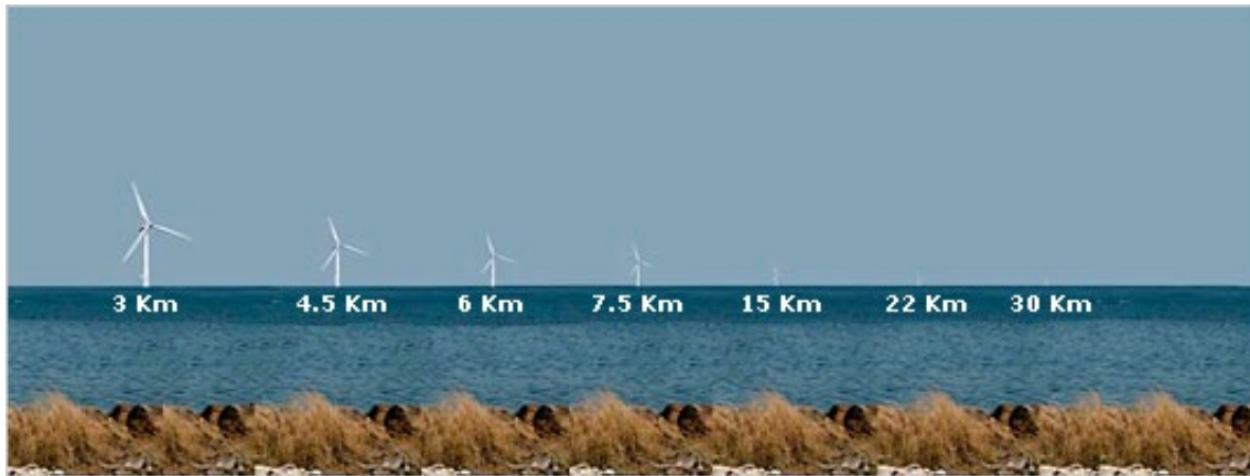
Figura 16: Percepción de los aerogeneradores sobre el horizonte en función de la distancia que se encuentre respecto a la costa. Fuente: Adaptada de [23].
