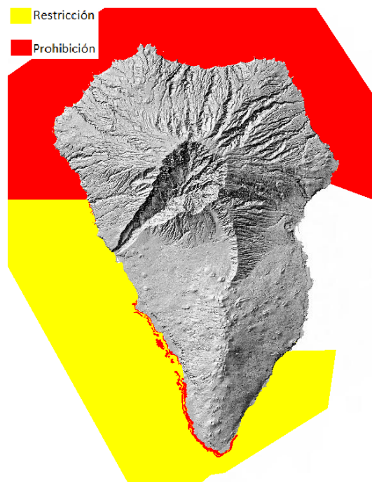
Figura 113: Restricciones para el emplazamiento de aerogeneradores marinos en la isla de La Palma. Fuente: Elaboración propia.
